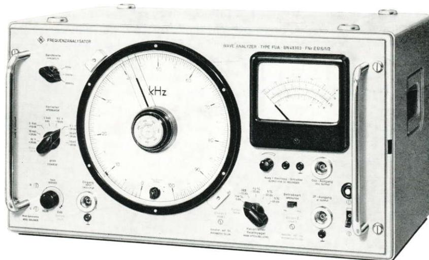
Der Frequenzanalysator Type FUA zerlegt Frequenzgemische nacheinander in ihre spektralen Anteile und mißt dabei für jede Frequenz die zugehörige Amplitude. Das Gerät ist mit allen Einrichtungen ausgestattet, die für die verschiedensten Anwendungen eine genaue und rasche Messung ermöglichen. Es ist sowohl als Analysator für Relativmessungen von Frequenzkomponenten wie auch als selektives Röhrenvoltmeter für absolute Spannungsmessungen geeignet.
